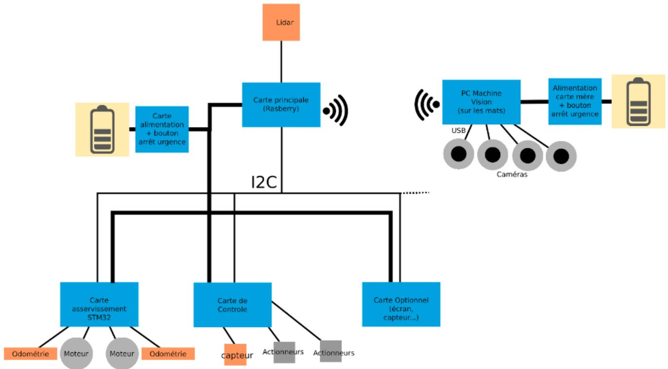
La partie machine vision ne va probablement pas être réalisé sauf si quelqu'un est très motivé. Le robot doit donc être capable de fonctionner sans (comme 95% des robot de la coupe de France. Cela ne pose pas vraiment problème de ne pas avoir de machine vision)
